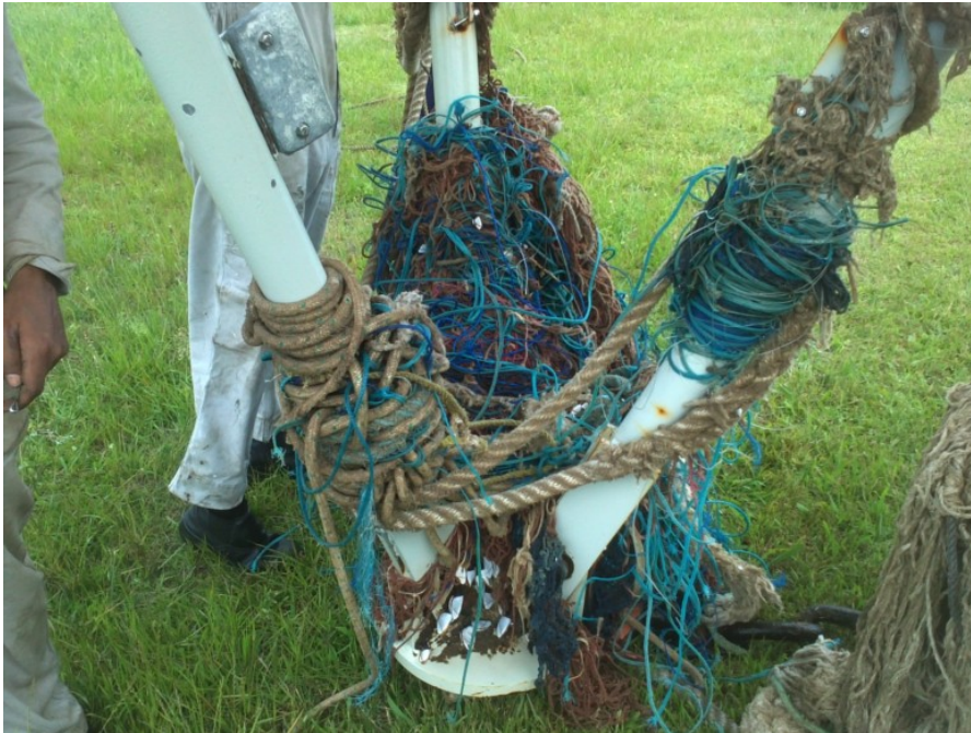
Figura 2: Foto da superestrutura da boia de SANTA CATARINA após recuperação em outubro de 2012.
